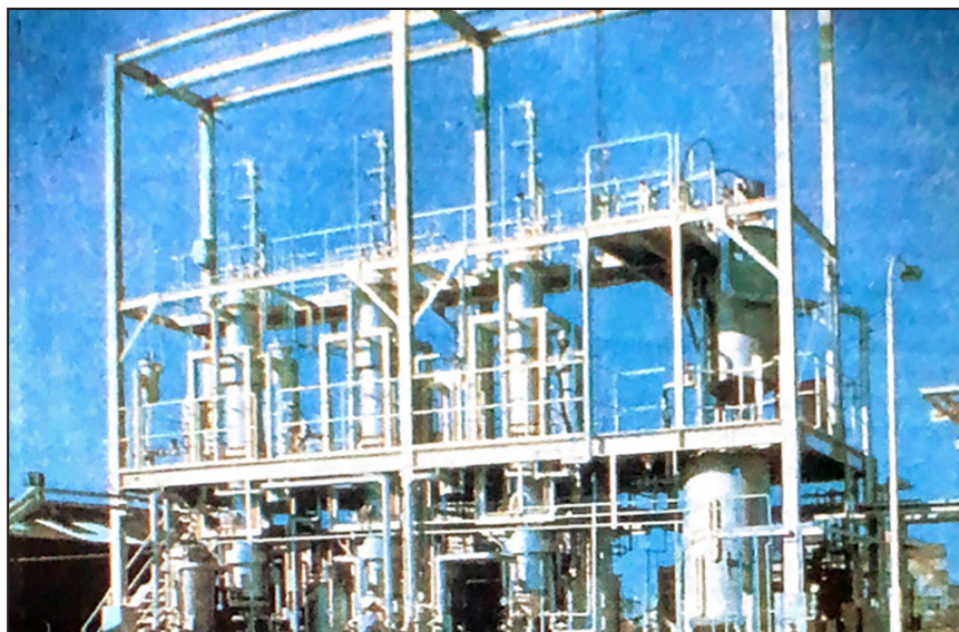
Рис. 36. Установка для производства этанола с использованием ферментаторов с иммобилизованными дрожжевыми клетками
