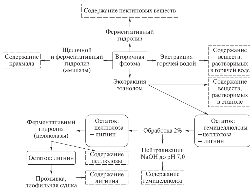
Рис. 3. Схема анализа компонентного состава вторичной флоэмы Fig. 3. Schematic diagram of secondary phloem component analysis
