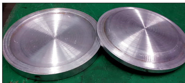
Рис. 6. Пресс-форма для прессования бумажных отливок Fig. 6. Press mold for pressing paper castings
