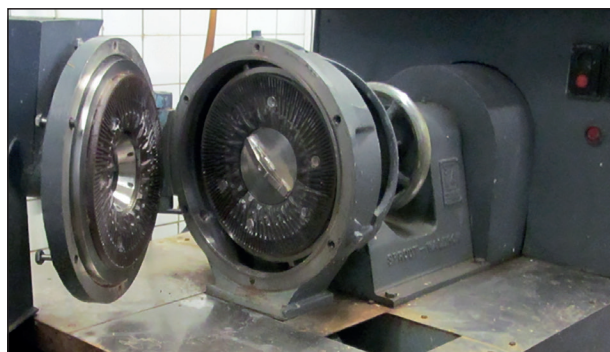
Рис. 5. Лабораторная дисковая мельница SW-12 Fig. 5. SW-12 Laboratory Disc Mill
