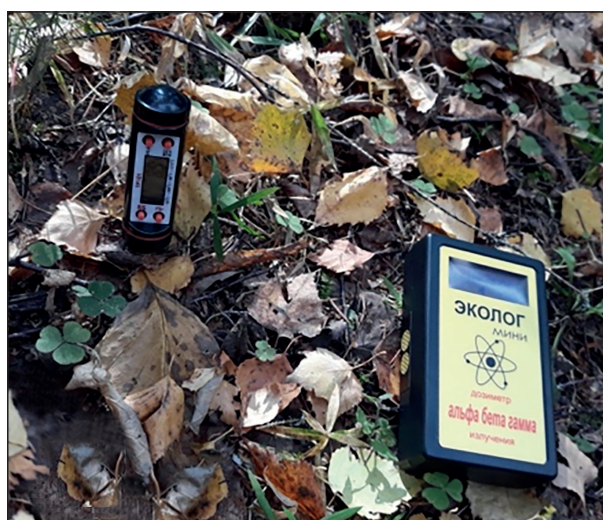
Рис. 2. Измерение радиационного фона и температуры почвы под пологом сосняка брусничного Fig. 2. Measurement of radiation background and soil temperature under the canopy of a vaccinium type pinery
