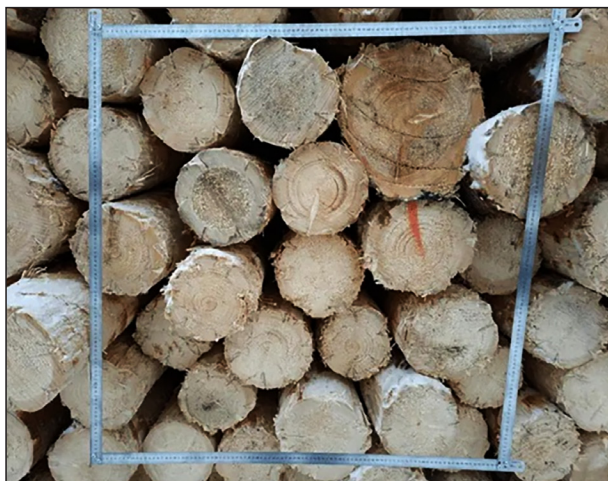
Рис. 3. Определение коэффициента полндревесности Fig. 3. Determining the timber density coefficient
