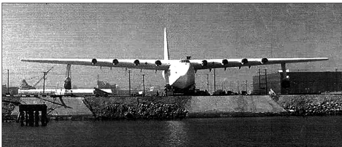
Рис. 3. Фанерный самолет Говарда Хьюза Fig. 3. Aircraft of G. Hughes from plywood
