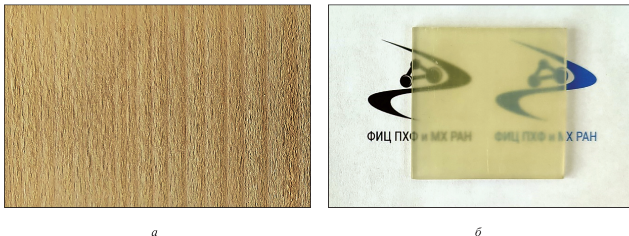
Рис. 1. Шпон бука (а) и прозрачный композит, состоящий из четырех слоев осветленного шпона бука, пропитанного эпоксидной смолой (б)
