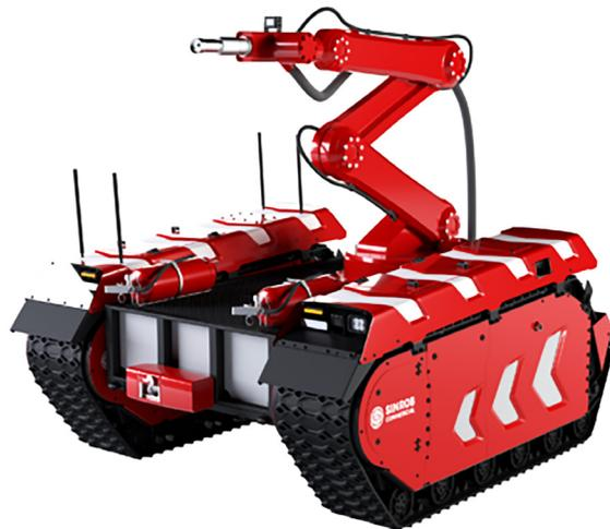
**Рис. 7.** Роботизированная платформа для тушения остатков очагов пожара — Multiscope Rescue Post-fire
