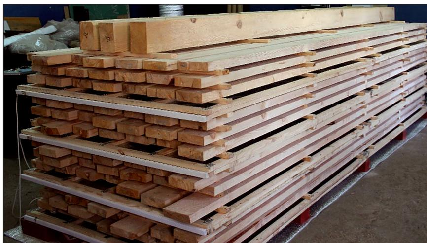
**Рис. 1.** Сушильная установка на основе низкотемпературных пленочных электронагревателей
