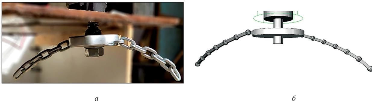
**Рис. 5.** Разгон ротора: *a* — прототип ротора; *б* — результат имитации для модельного времени 0,76 с
