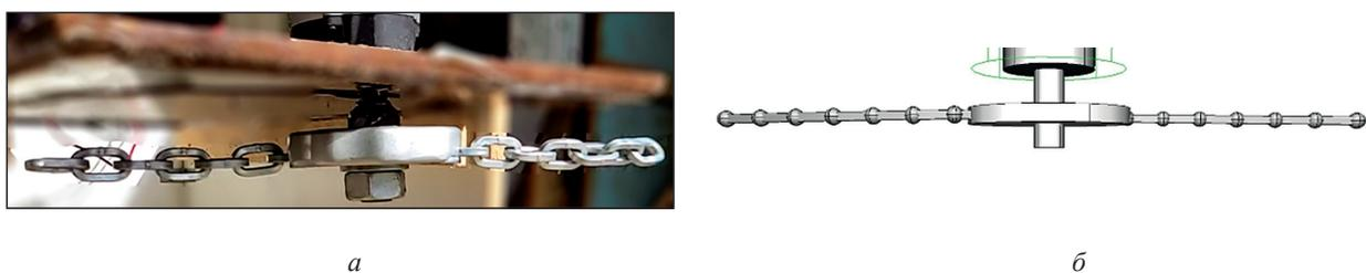
**Рис. 6.** Холостой ход ротора: *a* — прототип ротора; *б* — результат имитации для модельного времени 6 с
