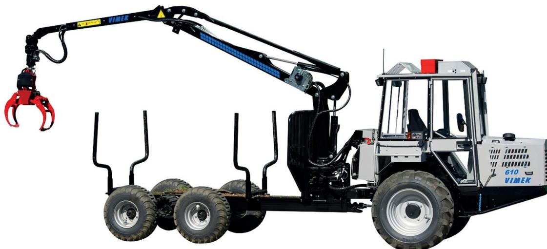
Рис. 22. Форвардер Vimek 610 на базе мини-трактора и прицепа
