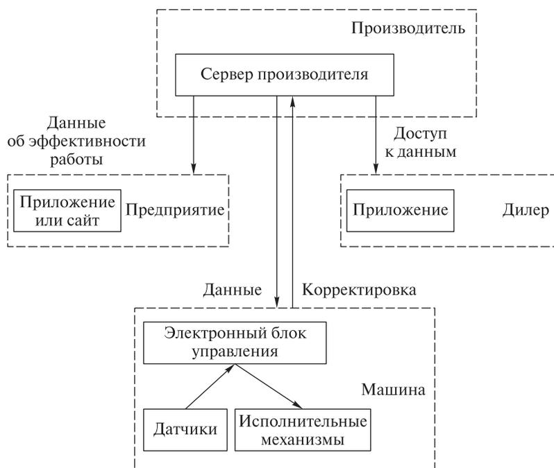
Рис. 3. Современная система диагностирования машин
