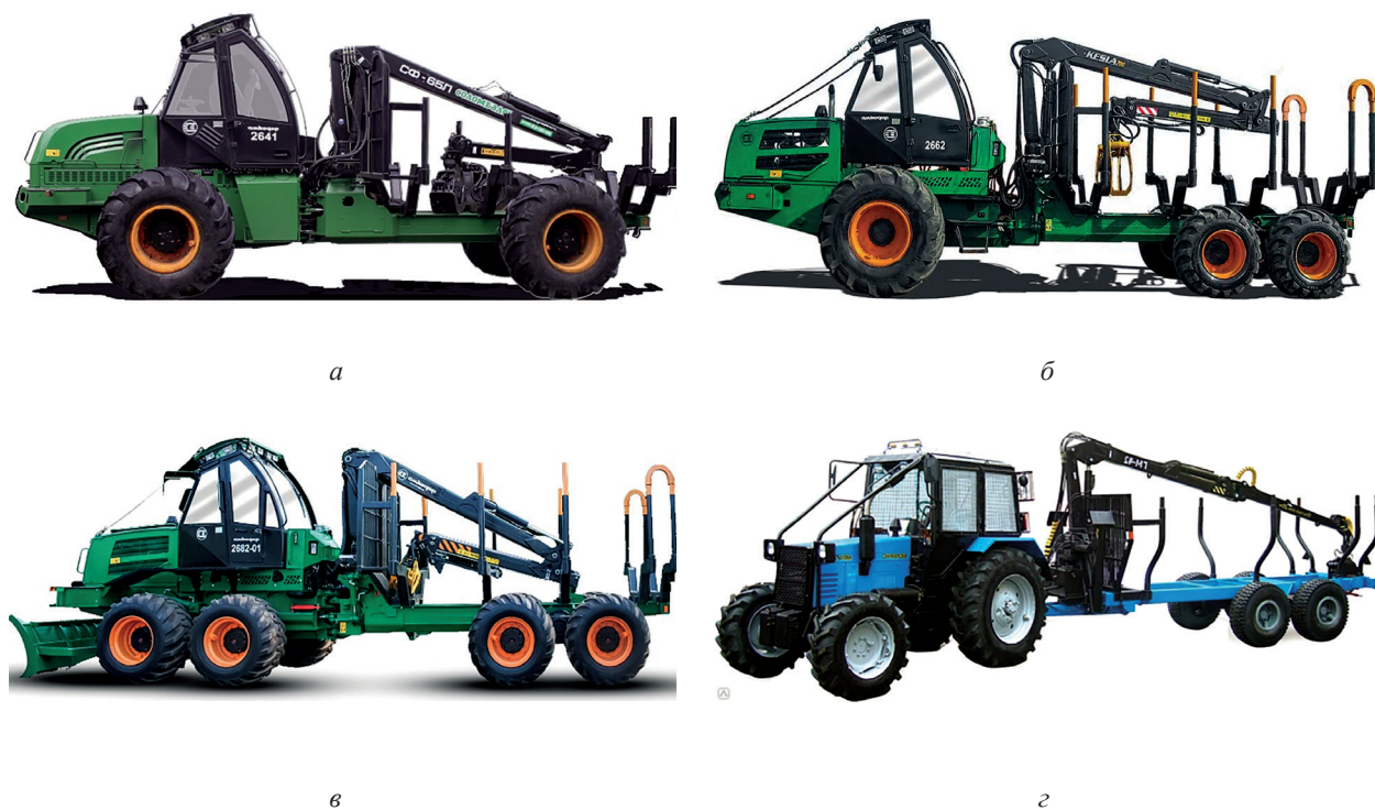
Рис. 1. Погрузочно-транспортные машины: а — колесная схема 4×4 (Амкодор-2641); б — колесная схема 6×6 (Амкодор-2661-01); в — колесная схема 8×8 (Амкодор-2682-01); г — двухзвенная компоновочная схема (Беларус МПТ 461.1)
