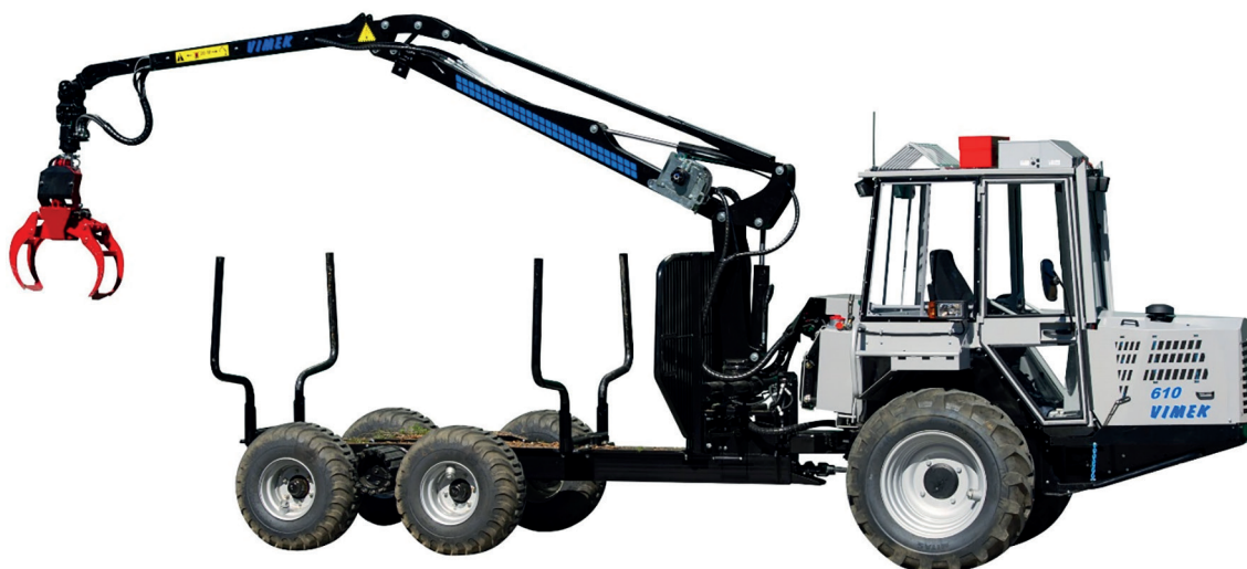
Рис. 22. Форвардер Vimek 610 на базе мини-трактора и прицепа Fig. 22. Vimek 610 forwarder based on mini-tractor and trailer
