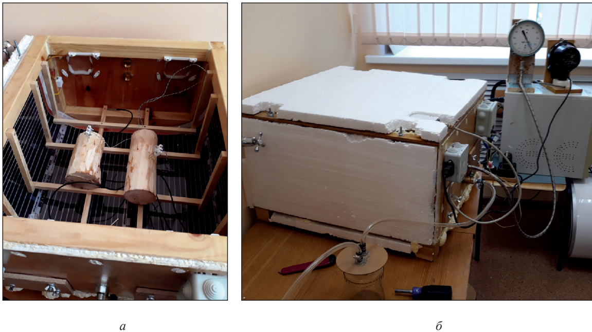
Рис. 3. Внешний вид собранного и подключенного экспериментального образца: а — закладка березовых чураков в установку; б — готовая к работе установка Fig. 3. Overview of the assembled and connected experimental sample: a — putting birch logs into the unit; b — ready for operation unit
