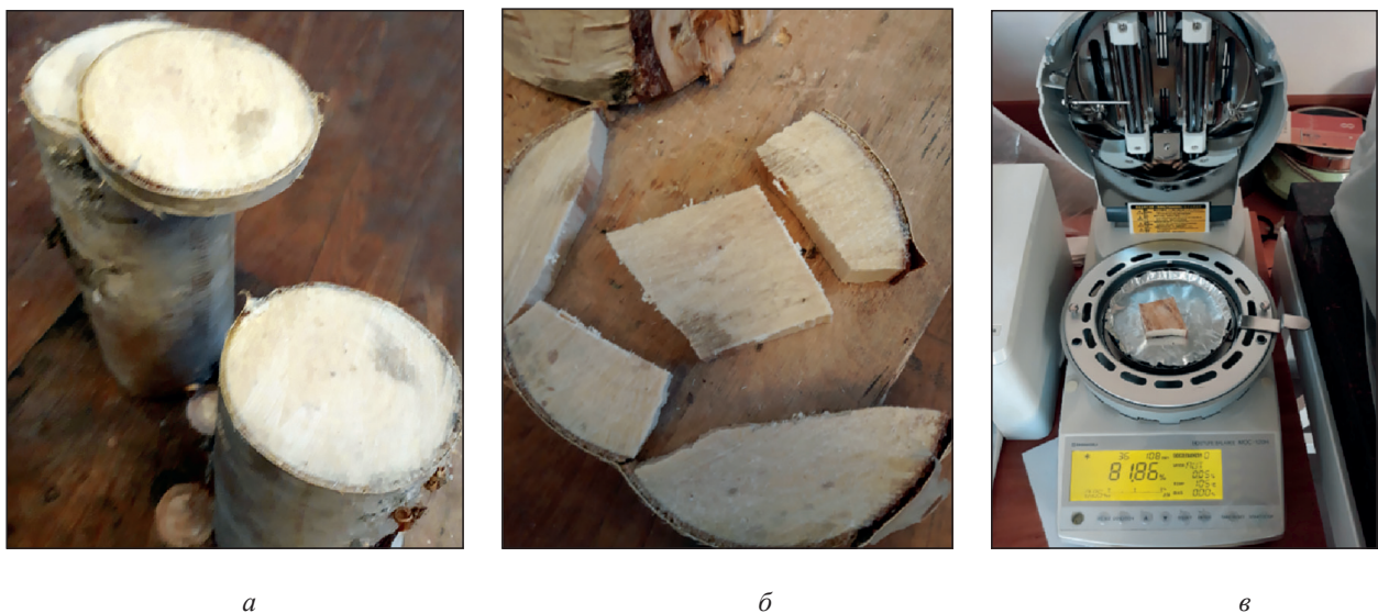
Рис. 4. Определение начальной влажности древесины по образцу: а, б — этапы получения образца; в — результат измерения влажности Fig. 4. Evaluation of the initial moisture content of wood on the sample: a, b — stages of obtaining the sample; c — the result of moisture measurement
