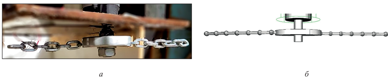
Рис. 6. Холостой ход ротора: a — прототип ротора; б — результат имитации для модельного времени 6 с Fig. 6. Rotor idling: a — rotor prototype; b — the result of simulation for a model time of 6 s
