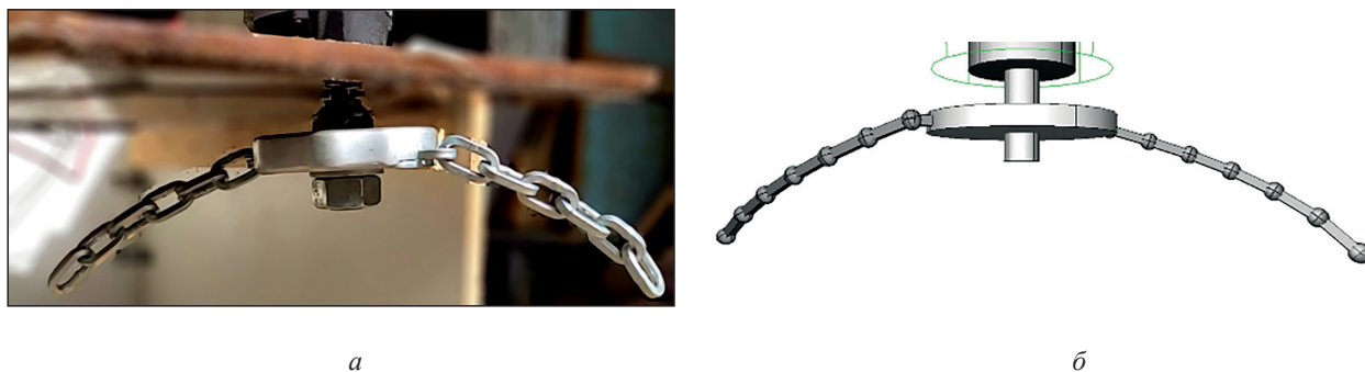
Рис. 5. Разгон ротора: a — прототип ротора; б — результат имитации для модельного времени 0,76 с Fig. 5. Rotor acceleration: a — rotor prototype; б — the result of simulation for a model time of 0,76 s
