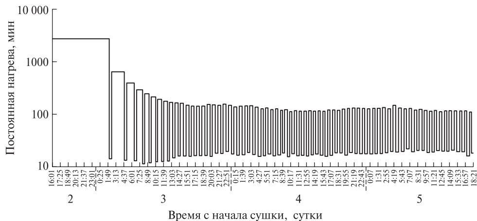
Рис. 10. Расчетные значения постоянной нагрева T_n по периодам с включенным и отключенным нагревателем для древесины по поддиапазнам фазы III
