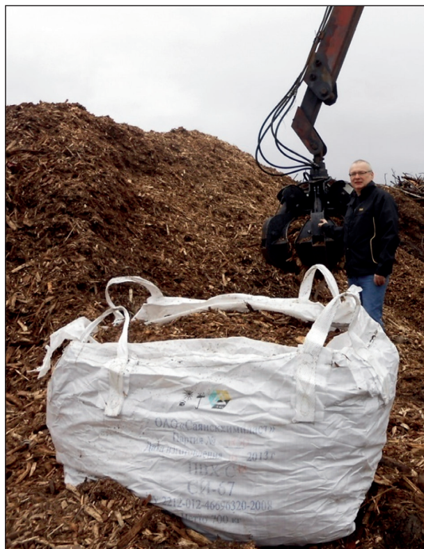
Рис. 3. Мягкий контейнер грузоподъемностью 700 кг со щепой (Щелковский учебно-опытный лесхоз, фото С.П. Карпачева)
