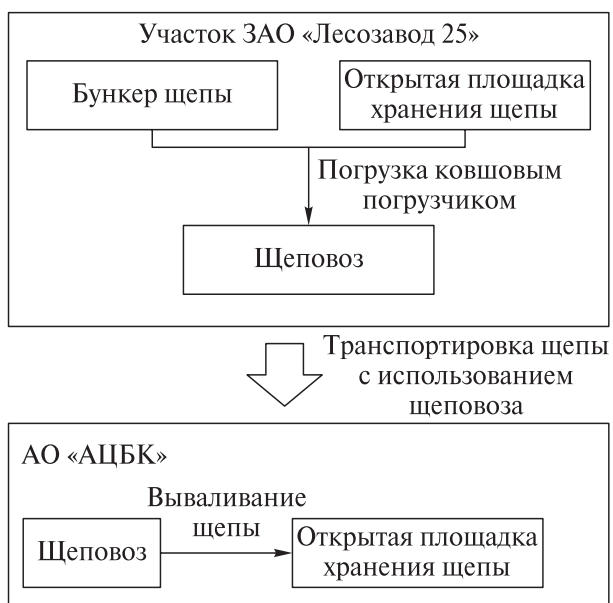
Рис. 2. Схема транспортировки щепы с применением автотранспорта Fig. 2. Scheme of chip transportation using motor transport
