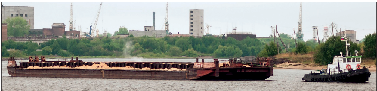
Рис. 4. Баржа (проект 945), используемая для транспортировки щепы
