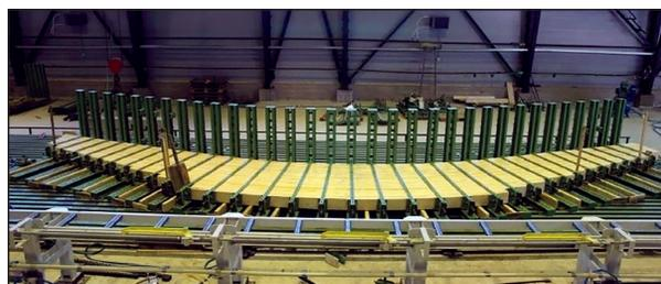
**Рис. 7.** Запрессовка клееных деревянных конструкций
