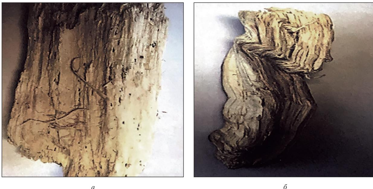
Рис. 7. Древесина березы, пораженная грибами белой гнили: *a* — в сухом состоянии; *б* — во влажном состоянии
