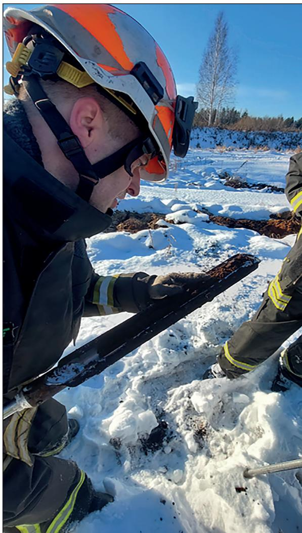
**Рис. 6.** Взятие проб буром-пробоотборником конструкции Инсторф
