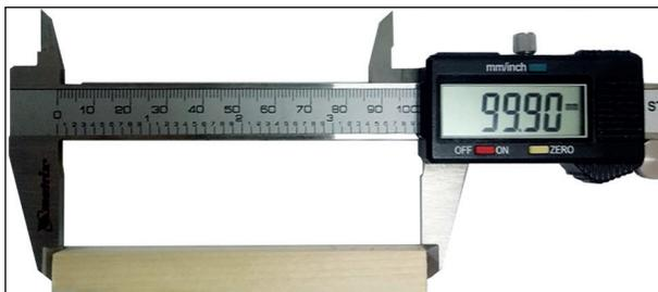
Рис. 2. Измерение геометрических размеров образцов
