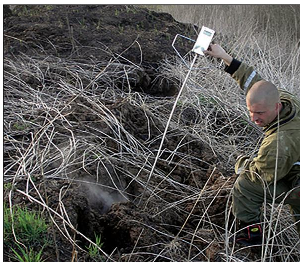
**Рис. 5.** Обследование бывшего штабеля торфа щупом-термометром
