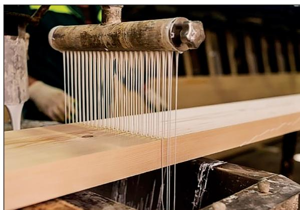
**Рис. 6.** Нанесение клея на заготовку из древесины
