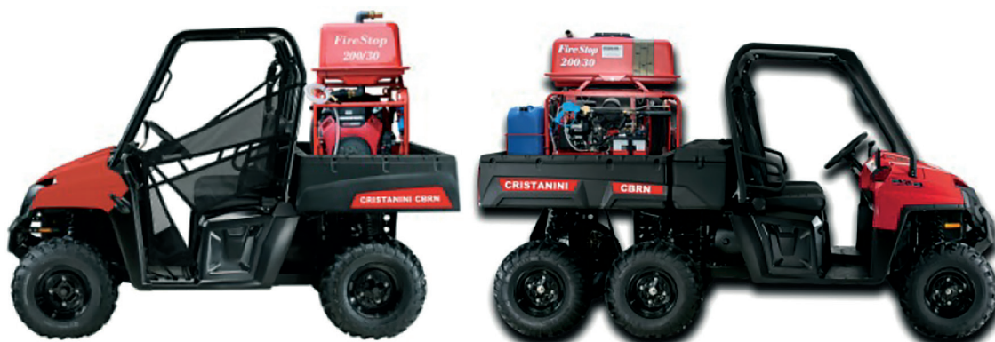
Рис. 3. Мини-машины высокой проходимости для размещения системы Fire Stop 200/30 Fig. 3. Mini-machines of high cross-country mobility to accommodate the Fire Stop 200/30 system
