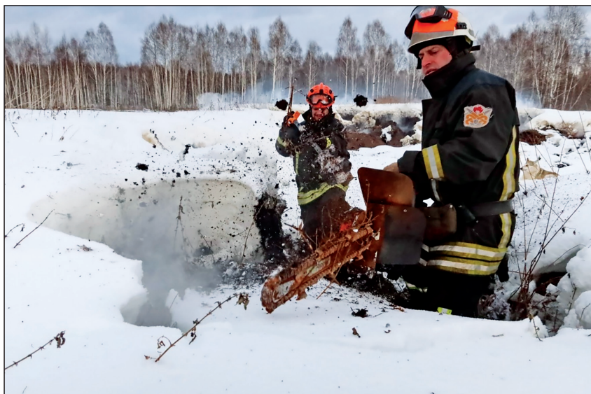
Рис. 14. Разрезание мерзлого грунта георипперами для исследования структуры очагов, обнаруженных по данным БПЛА
