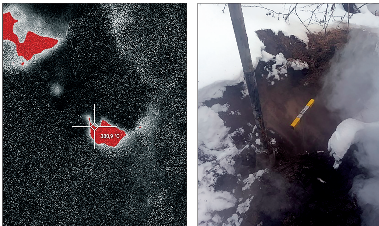
Рис. 12. Сравнение тепловизионного ( a ) и визуального ( б ) изображения очага тления Fig. 12. Comparison of thermal ( a ) and visual ( б ) images of a glow nest
