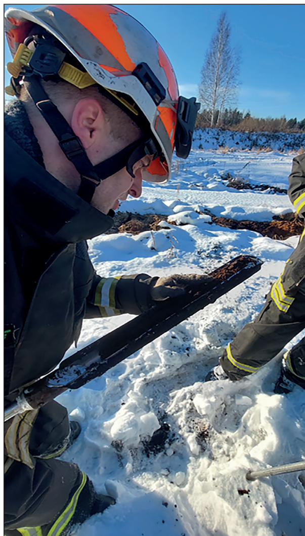
Рис. 6. Взятие проб буром-пробоотборником конструкции Инсторф Fig. 6. Sampling with an Instorf drill sampler
