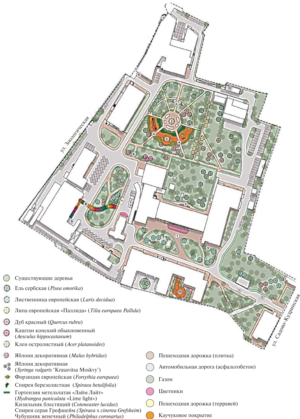
Рис. 6. Проект внешнего благоустройства территории ДГКБ № 13 им. Н.Ф. Филатова (автор Н.С. Соловьева): 1 — парадная территория перед главным корпусом; 2 — зона спокойного отдыха для пациентов младшего возраста с мамами; 3 — беседка садовая; 4 — арка с фонарем; 5 — специализированная площадка для центра медицинской реабилитации; 6 — арка с вывеской «Сад Филатовской больницы»; 7 — пандус для перемещения больных на каталках и колясках; 8 — навес для перемещения больных на каталках и колясках из корпуса № 3А в корпус № 6; 9 — колясочные для посетителей; 10 — спортивная площадка для сотрудников; 11 — площадки для обеспечения экстренного проезда автомашины скорой помощи; 12 — хозяйственно-техническая зона
