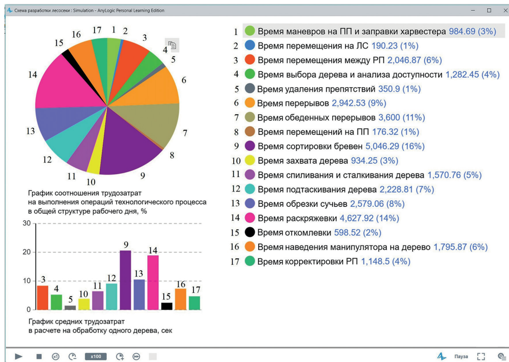
Рис. 1. Пример анализа отдельных элементов времени цикла работы харвестера на основе имитационного моделирования технологического процесса
