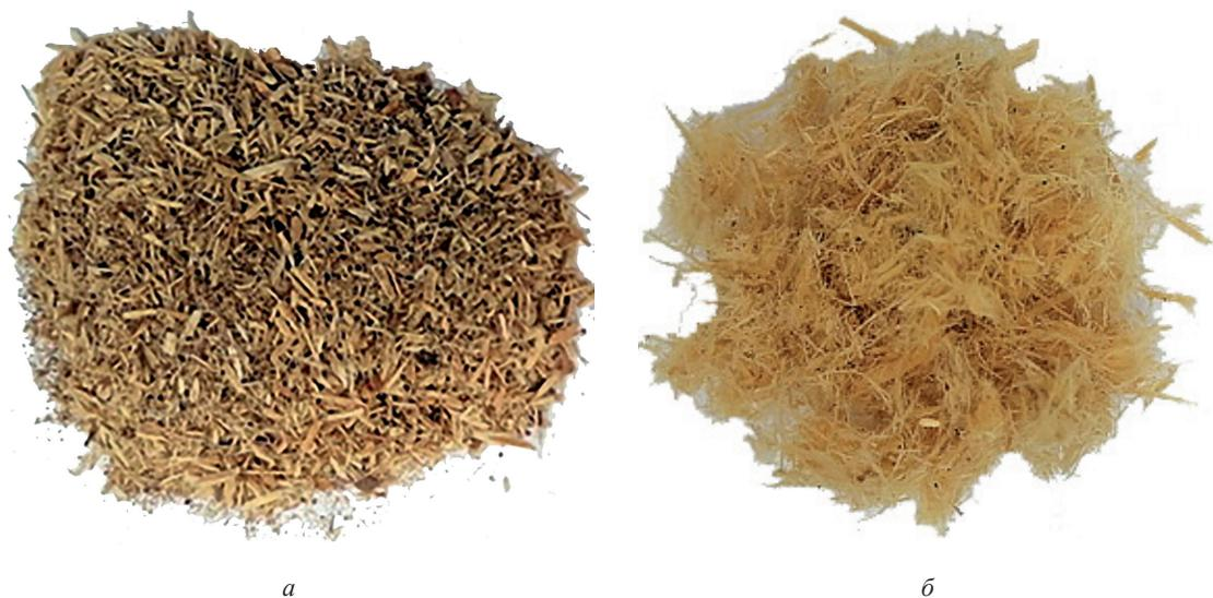
**Рис. 1.** Наполнитель для производства опытных образцов древесных плит: *а* — игольчатая стружка для ДСтП; *б* — рафинерное волокно для ДВП
