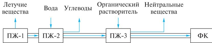
Рис. 9. Принципиальная схема фракционирования жидких продуктов пиролиза
