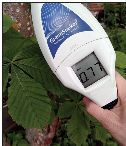
Рис. 1. Оптический датчик GreenSeeker® Handheld Crop Sensor для измерения индекса NDVI
