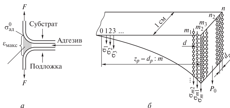
Рис. 12. Схема зоны деформации адгезива при нарушении АК расслаиванием по А.А. Чалых (а) [43] и по Н.И. Москвитину (б) [45]
