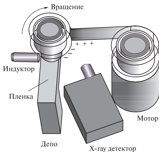
Рис. 10. Схема аппаратуры для изучения высоко-энергетической эмиссии при отслаивании — разматывании (rotation) с рулона липких лент в вакууме с помощью двигателя (motor) с оценкой свечения с использованием индуктора (inductor) и рентгеновского излучения с использованием X-лучевого детектора (X-ray detector) [9]
