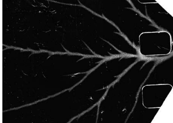
Рис. 8. Электрический разряд (стример), оставшийся на фотопленке при разматывании вблизи нее липкой ленты КЛТ на лавсановой основе
