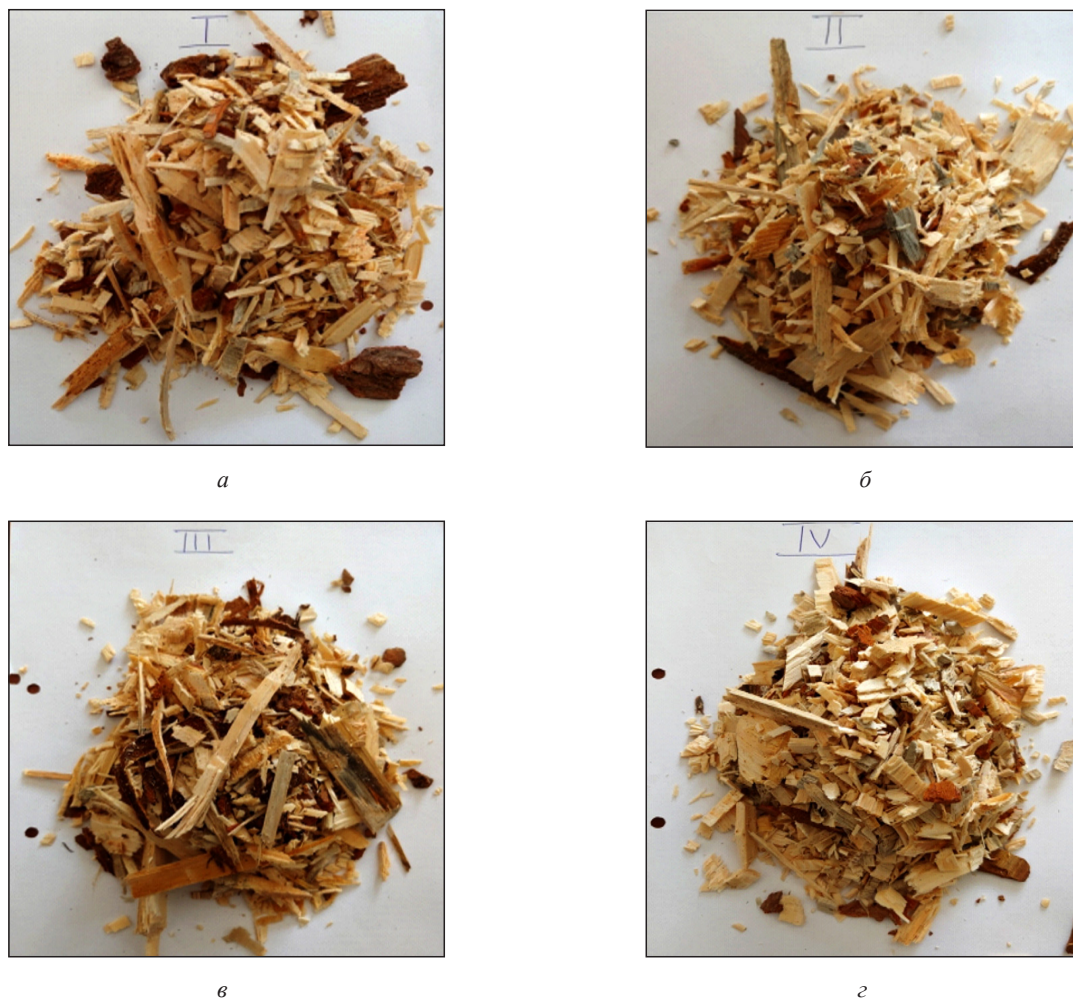
Рис. 10. Образцы проб измельченного материала при пропускной способности рубительной машины (м 3 /ч): а — 0,64; б — 1,87; в — 3,82; г — 6,5
