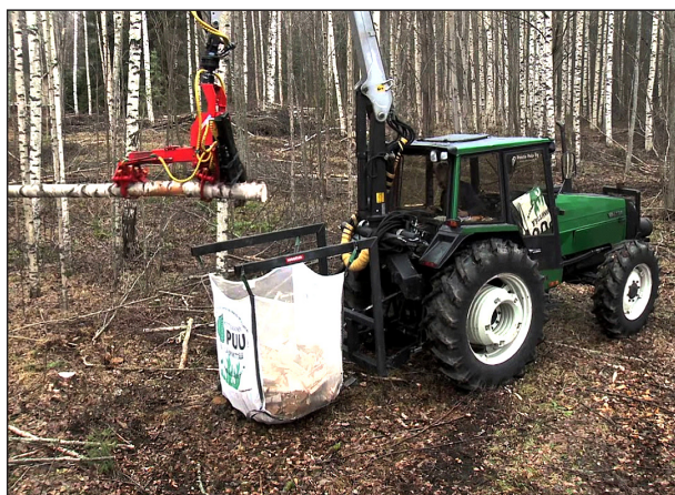
Рис. 4. Навесной древокольный процессор Naarva S23 [26]
