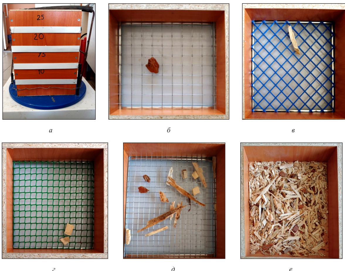
Рис. 6. Набор сит с отверстиями размером (мм): a — на расसेве РЛ; б — 25×25; в — 20×20; г — 15×15; д — 10×10; е — 5×5
