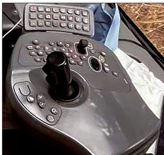
Рис. 2. Основные органы управления манипулятором Fig. 2. The main controls of the manipulator
