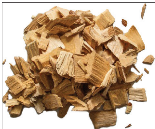
Рис. 1. Технологическая щепа березы перед обработкой раствором пероксида водорода и баротермическим гидролизом
