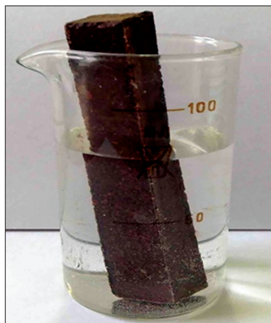
Рис. 8. Биопластик из прессмассы, включающей в себя 50 % здоровой древесины и 50 % «бурой гнили»
