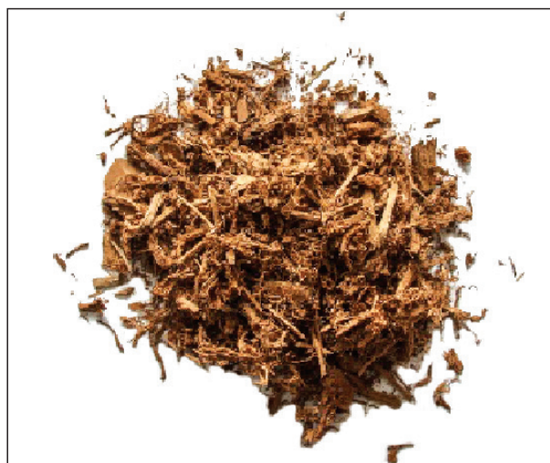
Рис. 2. Гидролизованная древесина березы Fig. 2. Hydrolyzed birch wood
