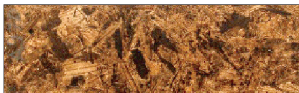
Рис. 3. Композитный материал из гидролизованной древесины березы Fig. 3. Composite material of hydrolyzed birch wood
