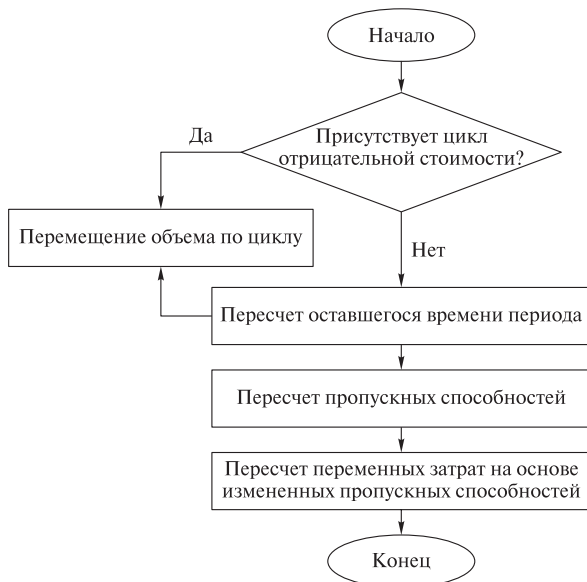
Рис. 7. Блок-схема алгоритма пересчета данных Fig. 7. Block diagram of the data recalculation algorithm
