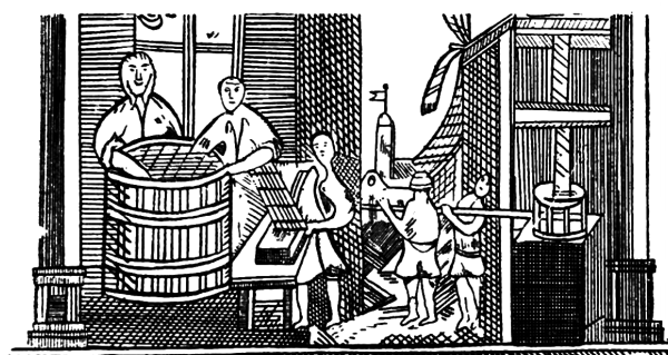
Рис. 2. Процессы ручного черпания и прессования бумаги на Ярославской мануфактуре (1730–1740 гг.) Fig. 2. The processes of manual scooping and pressing paper at the Yaroslavl manufactory (1730–1740)
