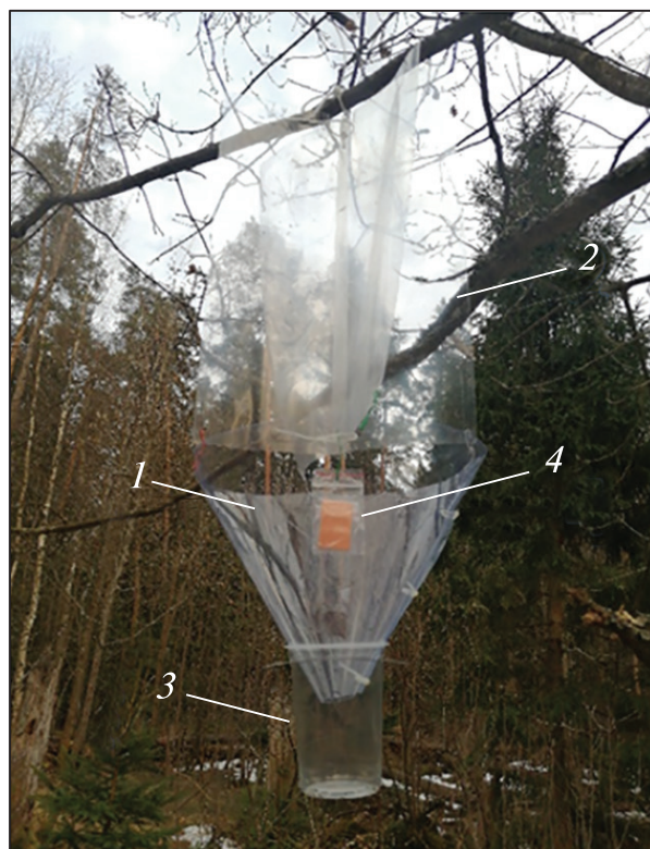
Рис. 2. Феромонная ловушка барьерного типа: 1 — воронка; 2 — барьер; 3 — съемный стакан; 4 — диспенсер Fig. 2. The pheromone trap: 1 — funnel; 2 — barrier; 3 — removable cup; 4 — dispenser
