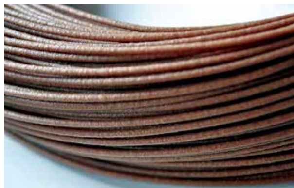
Рис. 1. Филамент для 3D-печати, сделанный на основе древесной стружки и PLA-матрицы
