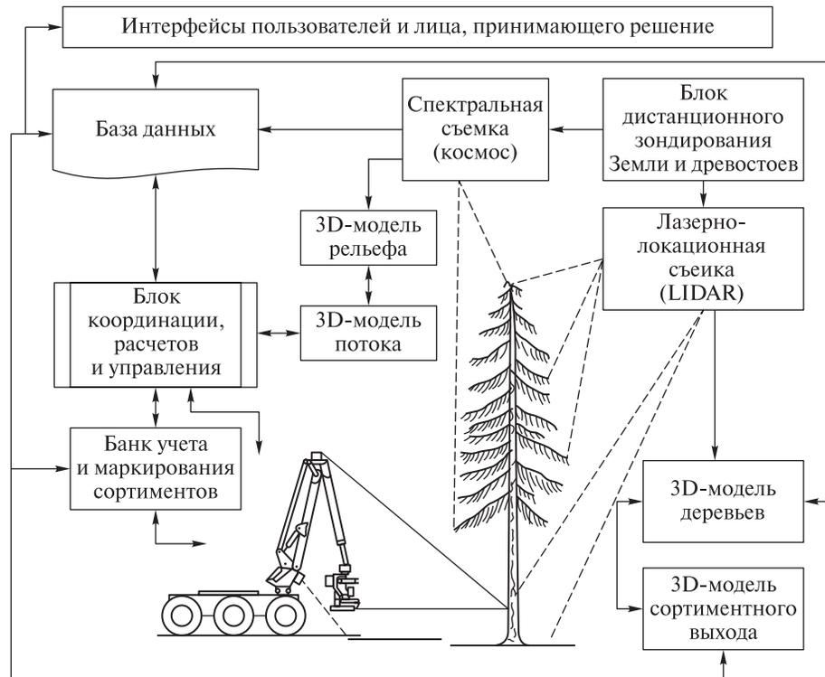
Рис. 1. Структурная схема автоматизированной системы управления технологическими процессами и информационными потоками лесопромышленной деятельности [7]
