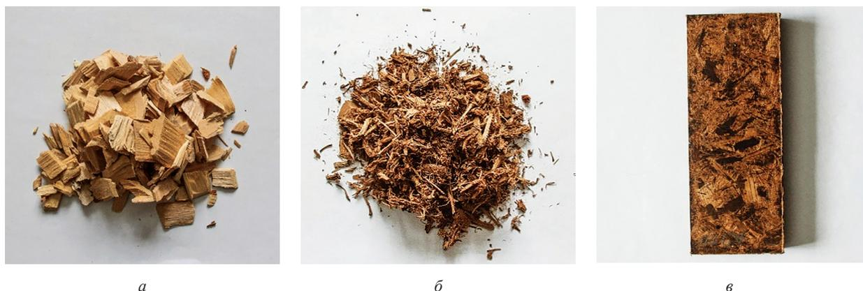
**Рис. 1.** Исходная щепа березы (а), гидролизованная щепа березы (б) и композиционный материал (в), полученный на ее основе
