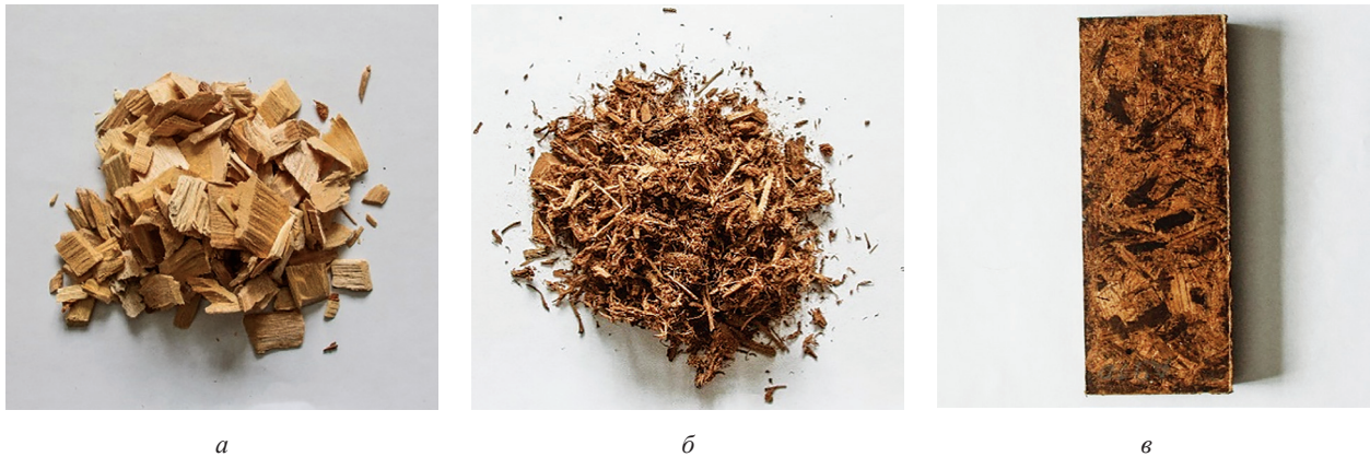
Рис. 1. Исходная щепа березы (а), гидролизованная щепа березы (б) и композиционный материал (в), полученный на ее основе Fig. 1. Initial birch chips (a), hydrolyzed birch chips (b) and composite material (c), obtained on its basis
