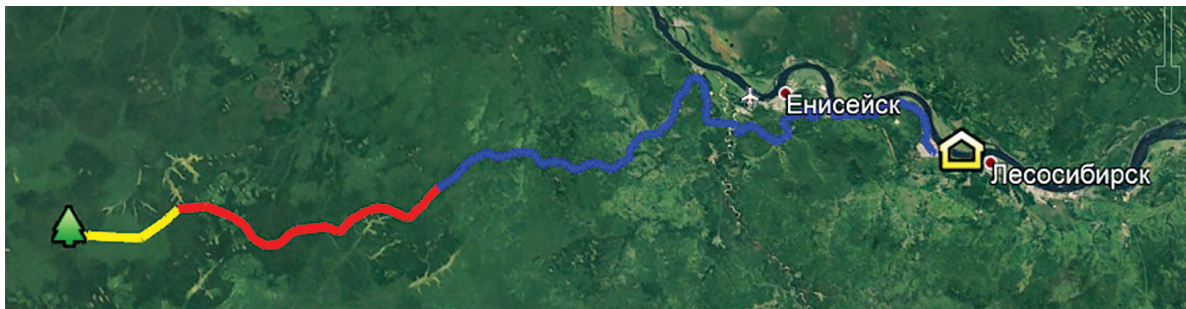
Рис. 1. Лесовозная дорога на территории Енисейского лесничества: дорога без покрытия (желтый); грунтовая дорога (красный); асфальтированная дорога (синий)
