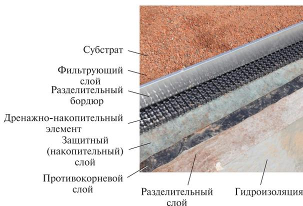
Рис. 4. Структура зеленой крыши экстенсивного типа [10]
