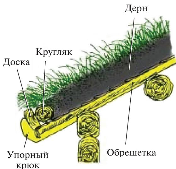
Рис. 2. Ограждающий элемент из доски и кругляка
