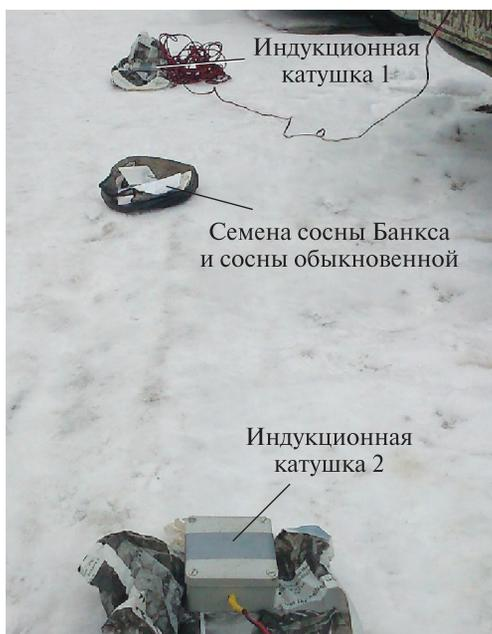
Рис. 2. Процесс обработки семян низкочастотным электромагнитным полем
