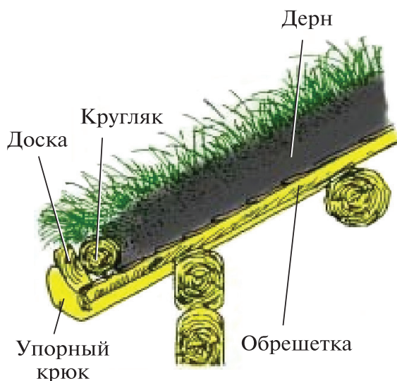
Рис. 2. Ограждающий элемент из доски и кругляка Fig. 2. Filing element made of boards and round wood
