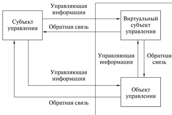
Рис. 2. Обобщенная структурная схема лабораторного стенда
