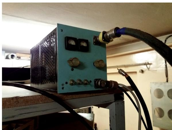
Рис. 3. Задающий генератор Г4-102 и предусилитель
